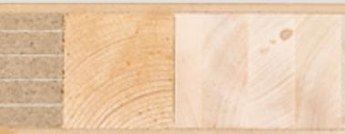
Spezial Mittellage für erhöhten Schall- und Wärmedämmwert, Mittellage mit verstärktem Konstruktionsaufbau für hohes Stehvermögen. Beidseitig abgesperrt mit Klimadeck. 4-seitig Kanten aus Birke (europäische Herkunft) als Einleimer.
