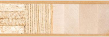
Mittellage stranggepresste Spanplatte, mehrlagiger Kombinationsaufbau für erhöhte Schalldämmung, verstärkter Konstruktionsaufbau für EI30. Beidseitig abgesperrt mit Hartplattendeck, wahlweise mit Klimadeck. 4-seitig Kanten aus Birke (europäische Herkunft) als Einleimer. Oberfläche roh zum Streichen.
