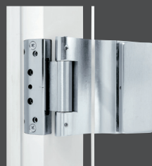
Ausführung GT/M V-3D Bandaufnahme 3-dimensional verstellbar bei eingehängtem Türblatt, für schwere und groß- formatige Türen konzipiert, einfache Montage (Standardlieferausführung)
