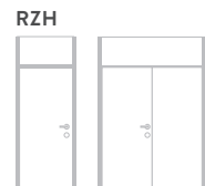
Raumhohe Zarge ohne Querteil mit Kämpfer und Oberlichte bis Raumlichte von 2.600 mm (einflügelig, zweiflügelig)
